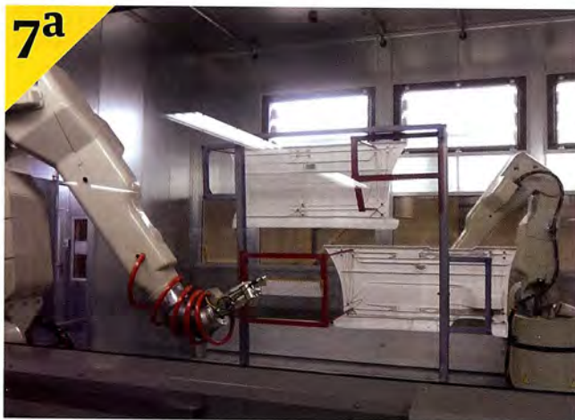
7a. Het spuiten gebeurt in afgesloten ruimtes, want al een klein stofje kan later zichtbaar zijn in de gedroogde lak. Op de drie spuitlijnen bewegen de robots om de onderdelen heen. De spuitbreedte en de dosering worden automatisch geregeld en bijgesteld. Na de eerste laklaag gaat de skid 12 minuten in een droogoven van 90 °C. Daarna volgt nog een laklaag. Is de lak op waterbasis, zoals bij de metallic-kleuren, dan komt er nog twee keer een transparante topcoat overheen. Bij elektrostatisch spuiten worden de onderdelen vooraf eerst gespoten met een zwarte 'conductive primer' om de elektrische geleidbaarheid te verhogen.
